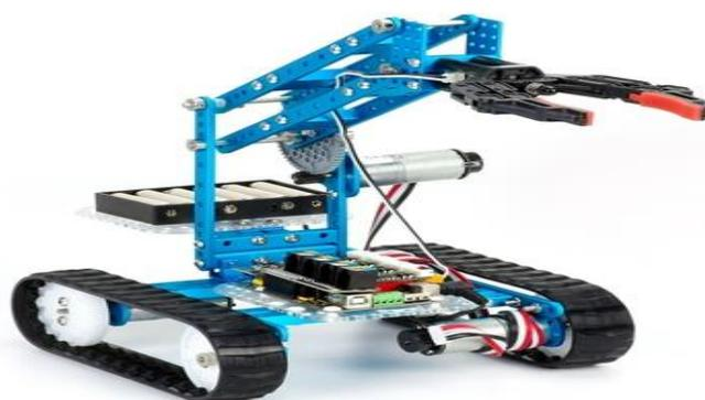
Рис.3 - Готовая модель робота «Танк с роборукой/ Роборука на гусеничном ходу»
